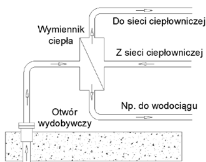
Rys. 4. Jednotworowy system eksploatacji słodkiej wody termalnej z przeznaczeniem zarówno do celów energetycznych, jak i rekreacyjnych oraz leczniczych
